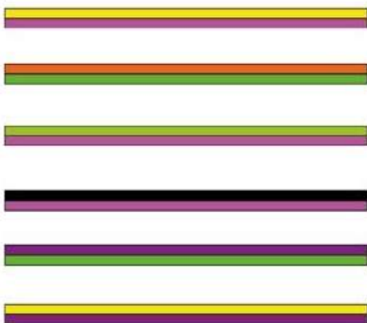
Proposte colori per i fili dei detonatori / Possible color combinations for detonator wire
