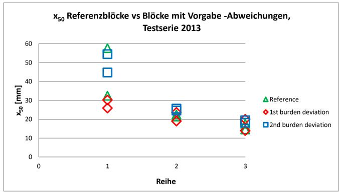
FIG 6 – Median fragment size x50 values plotted row wise for blocks shot in 2013 Referenzblöcker vs Blöcker mit Vorgabe-Abweichungen, Testserie
