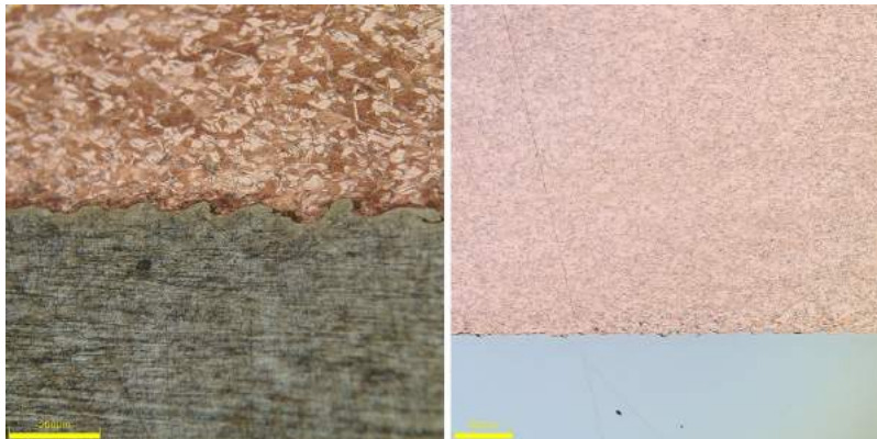
10. ábra: 200 \mu\text{m} (b); és 500 \mu\text{m} (j) felbontású felvétel a vörösréz és a KO33 acél között kialakult kohéziós kötésről 17
