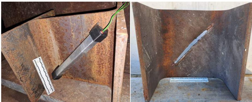
6. ábra: A lineáris vágótöltet elhelyezése és behatolása IPE 15 400 acélgerendába (a szerző saját felvétele)
