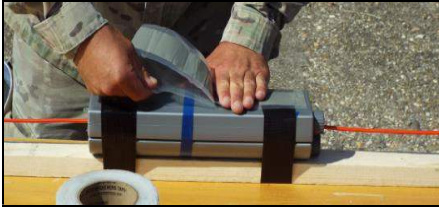
7. kép: Breacher's Tape felhelyezése a töltetre (a szerző felvétele)
