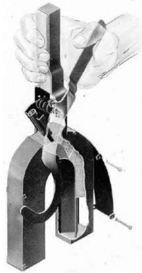
15. ábra: Amerikai Mark 1 kábelrobbantó töltet [20. p. 16]
