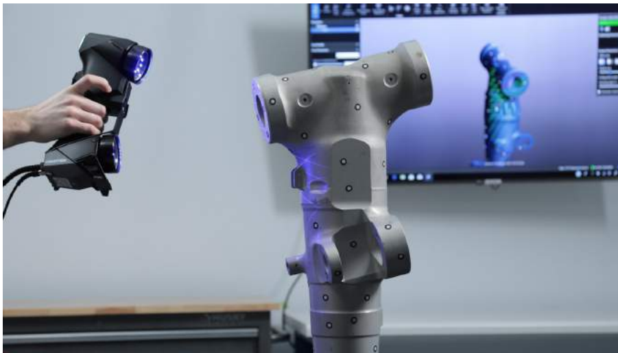
2. ábra: Egy 3D lézerszkennert alkalmazás közben [4]
