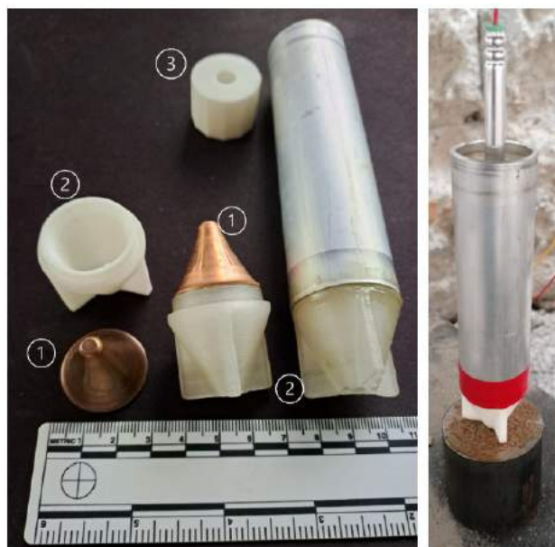
1. ábra: A kumulatív töltet részei, és az összeállított töltet a céltárgyon (a szerző saját felvétele)
