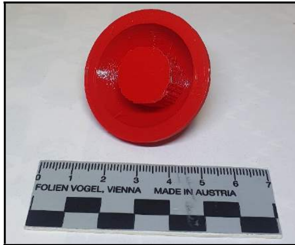
2. kép: FDM eljárással készült félgömb béléstest a támaszával (készítette a szerző)
