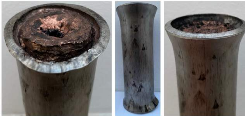
12. ábra: KO36-Vörösréz tengelyszimmetrikus plattírozott termék (a szerző saját felvétele)
