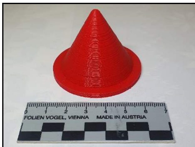
1. kép: FDM eljárással készült bélés-kúp (készítette a szerző)
