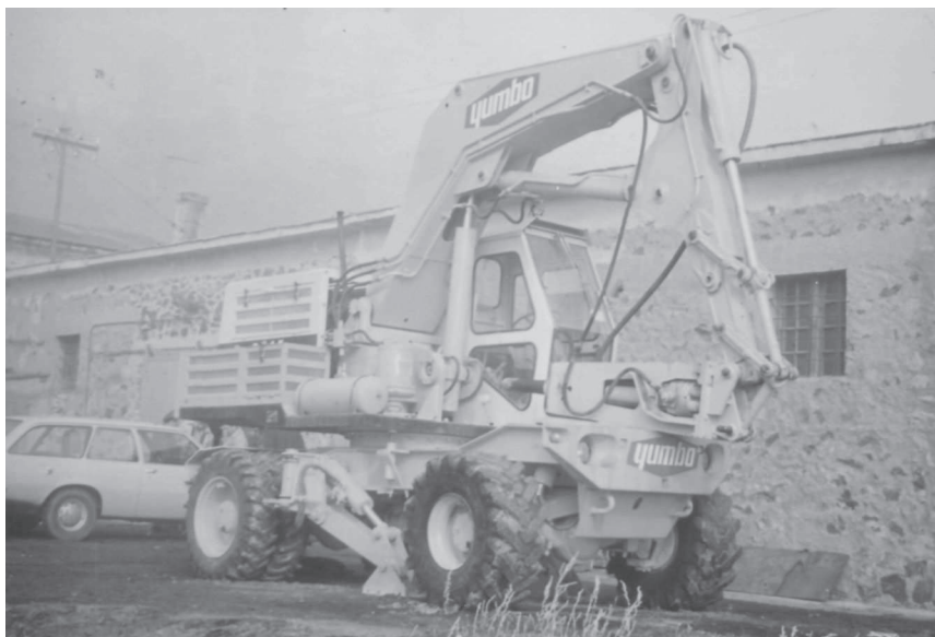
18. Gumikerekes Yumbo kotró, hidraulikus kalapáccsal
